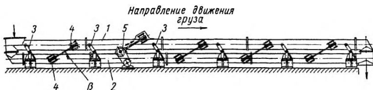
Рис. 1. Схема двухмассного уравновешенного вибрационного конвейера с резинометаллическими упругими связями
