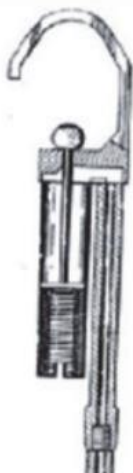
Рис. 6. Пневматическое устройство для механического удаления льда с провода
