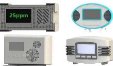
Рис. 2. Твердотельные модели устройства контроля угарного газа
