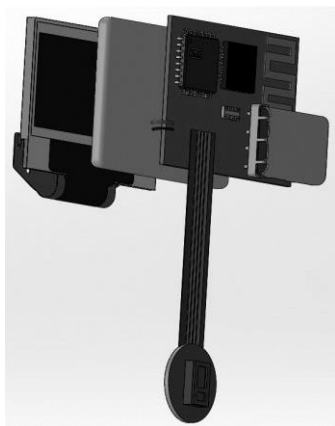
Рис. 1. Твердотельная модель электронного узла пульсоксиметра
