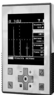
Рис. 1. Твердотельная модель цифрового дефектоскопа
