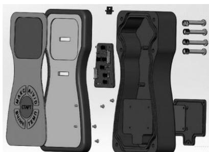
Рис. 1. Твердотельная модель измерителя вибрации
