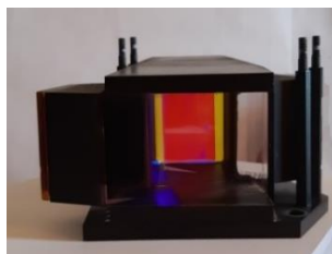
Рис. 1. Оптическая схема (а) и общий вид оптической сборки (б) цветоделительного блока
