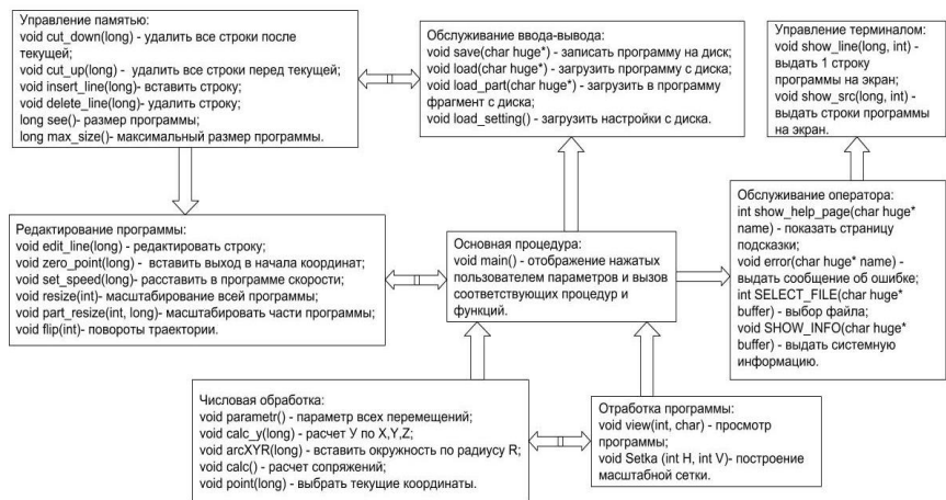
Рис. 1. Схема автоматизированной подготовки программ управления элементами технологического модуля лазерного комплекса
