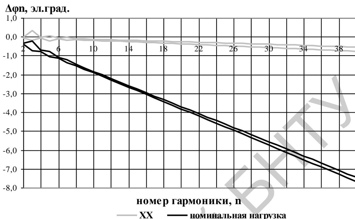
**Рисунок 4 – Результаты измерений угловой погрешности трансформатора напряжения типа НОМ-6, представленные доверительным интервалом с вероятностью 0,95**
