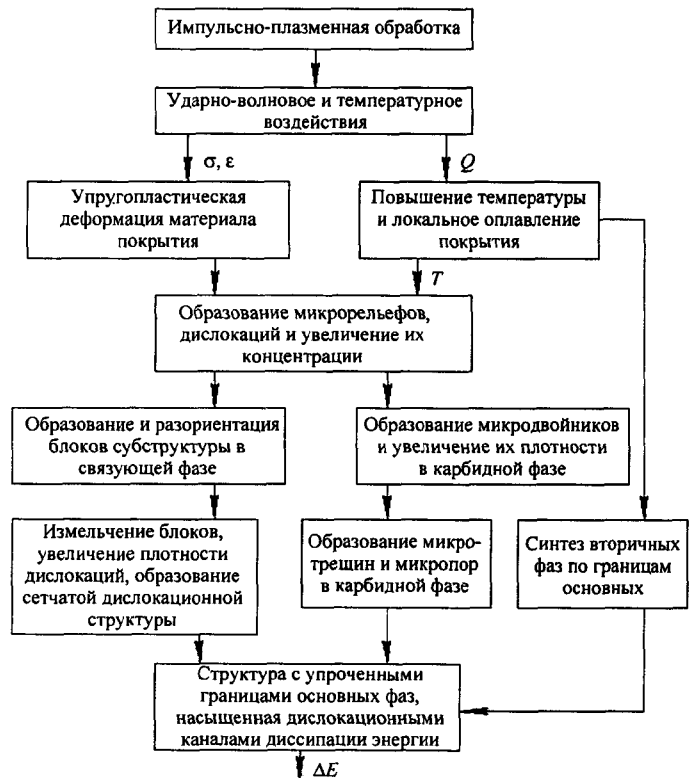
Рис. 2. Физическая модель формирования дислокационной структуры напыленных композиционных покрытий, обработанных импульсами плазменной струи
