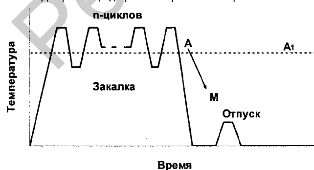
Рис. 2. Диаграмма УТЦО стали У8, включающая термоциклирование выше и ниже критической точки A_1 с закалочным охлаждением на последнем цикле и отпуском
