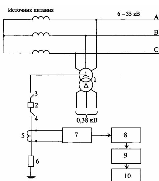
Изобретение относится к электроэнергетике, а именно к автоматическому контролю состояния изоляции трехфазных электрических сетей напряжением 6-35 кВ с заземленной через резистор нейтралью.
