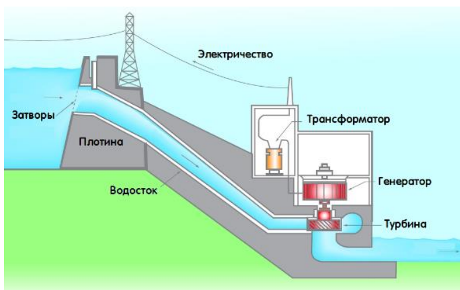
Рисунок 2 - Принцип работы ГЭС
