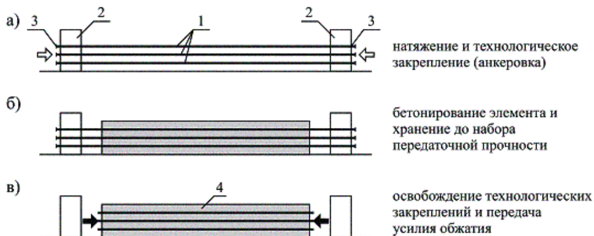
Рис. 1.11. Последовательности технологических операций при предварительном напряжении арматуры на упоры 1 – напрягаемая арматура; 2 – упоры; 3 – технологические анкера; 4 – железобетонный элемент
