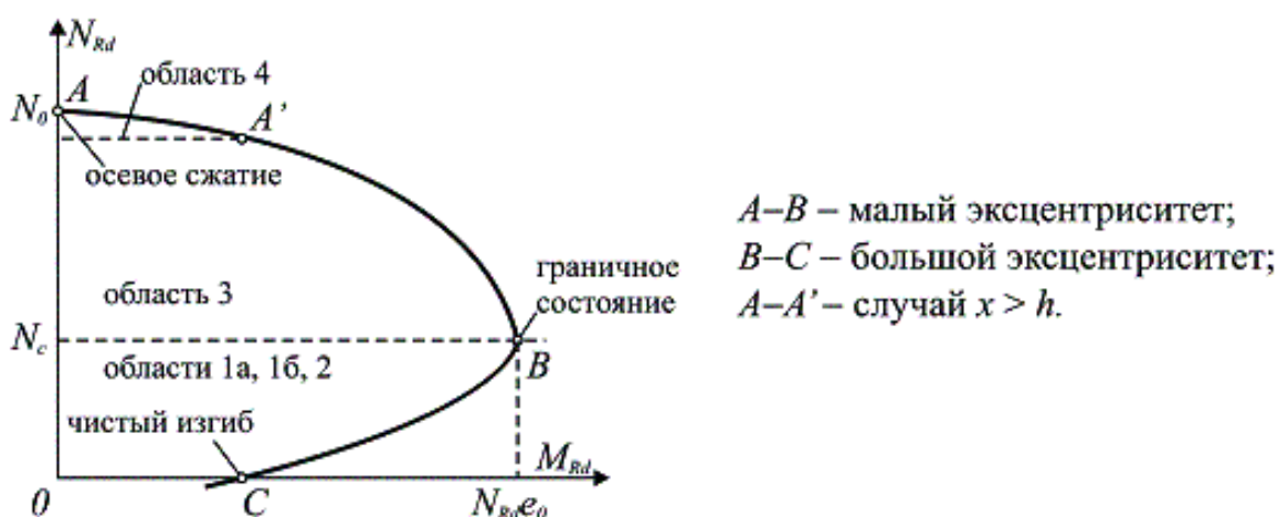
Рис. 1.23. Схематичная кривая взаимодействия « N_{Rd}-M_{Rd} » для внецентренно сжатого сечения
