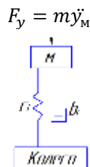
Рисунок 2 – Схема динамической модели малогабаритного автомобиля LABO
