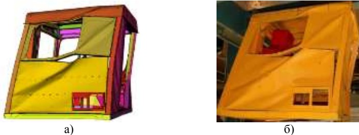
Рисунок 4 – Результаты виртуальных (а) и натуральных (б) испытаний ROPS на соответствие техническим требованиям ISO 3471
