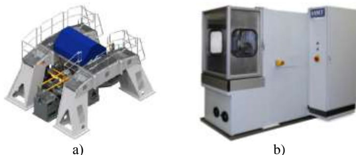
Рисунок 1. а) – 12 канальный стенд для испытания подвески автомобиля и его силовой структуры, б) – стендовое оборудование для испытания ступичного узла с учетом влияния окружающей среды
