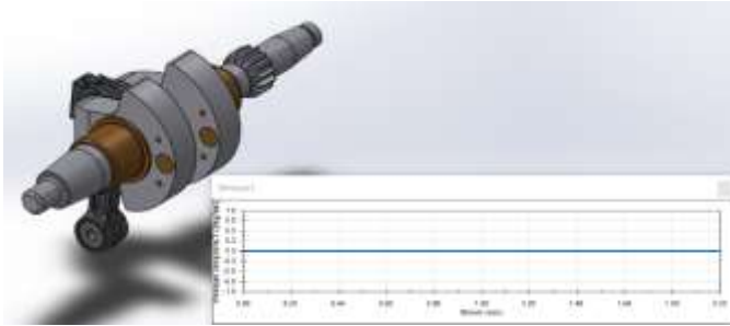
Рисунок 2 – Зависимость угловой скорости от времени для уравновешенного коленчатого вала
