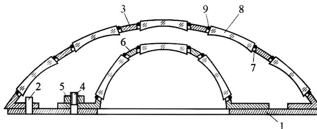
Инструмент предназначен для закрепления линз в виде отрицательного мениска в блоки в случае их шлифования и полирования на станках для двусторонней обработки оптических деталей и может быть использован в оптическом приборостроении.
