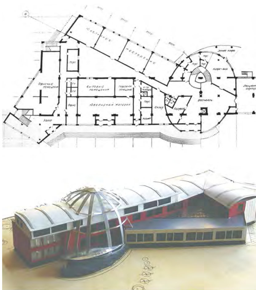
Рис. 5.11. Проект реконструкции щеточной фабрики в г. Минске с включением дополнительных объемов и пристроек
