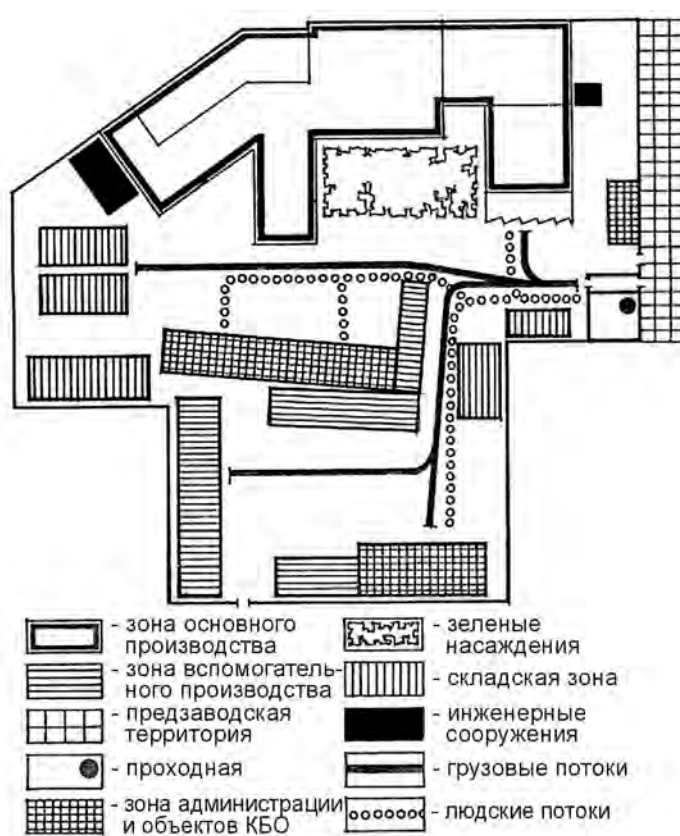
Рис. 8.3. Схема анализа транспортно-пешеходных связей и размещения зданий различного функционального назначения на территории предприятия
