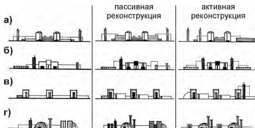
Рис. 4.9. Трансформация фронтальной композиции застройки промышленных предприятий: а - симметрично-осевая, б - осевая, в - нейтральная (ритмическая), г - свободная
