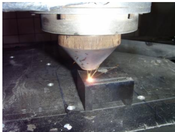
Рисунок 1- Объектив для лазерной наплавки Рисунок 2- Процесс лазерной наплавки
