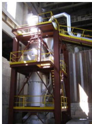
Печь кипящего слоя фирмы «Смидт» Опытно-промышленная печь циклонного типа
