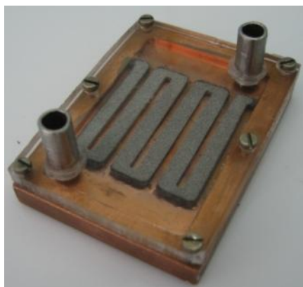
Фото теплообменника с пористым теплоотводящим элементом и фото
