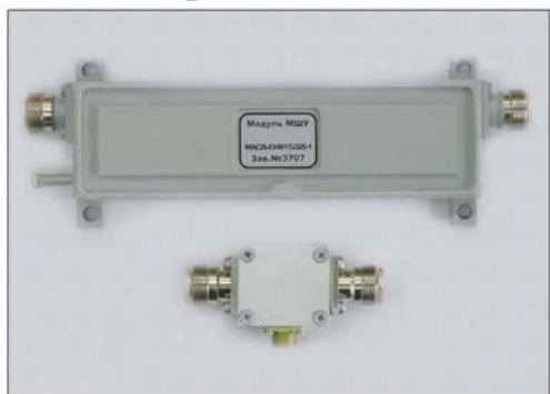
Маломощный усилитель L-диапазона с адаптером питанием по центральной жиле.
