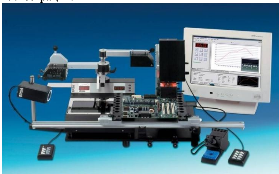
Рисунок 1 – Состав инфракрасного паяльного комплекса
