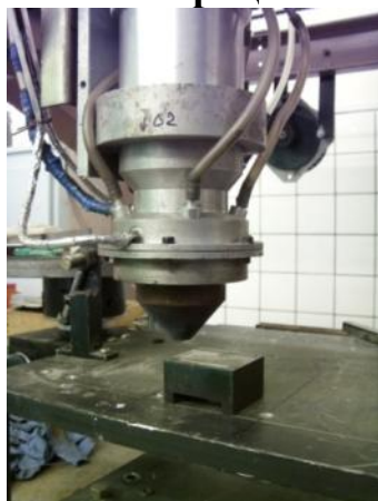
Рисунок 1- Объектив для лазерной наплавки Рисунок 2- Процесс лазерной наплавки
