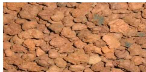
Рисунок 2 – Керамзит, полученный с использованием шламов гальванического производства
