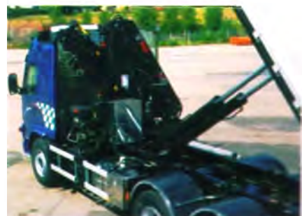
Рис. 1. Грузовые автомобили, оборудованные манипуляторами: а – с бортовой платформой, б – с самосвальным кузовом
