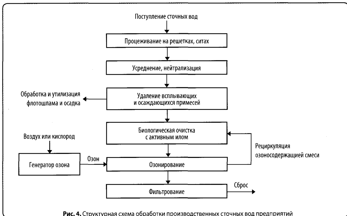
Рис. 4. Структурная схема обработки производственных сточных вод предприятий текстильной промышленности
