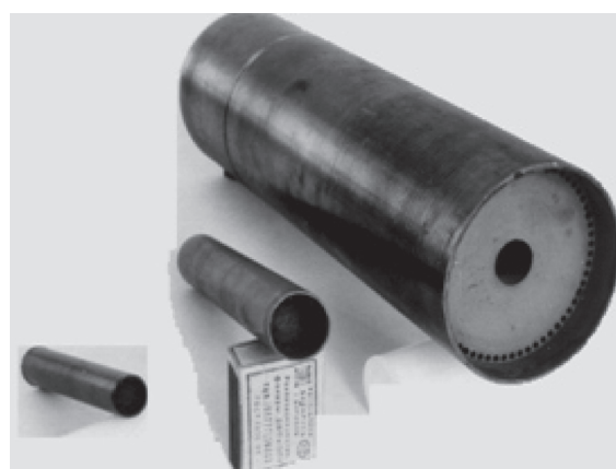
Рис. 8. Испарители КТТ с капиллярной структурой из порошков Ni, Cu, Ti, Al [1]
