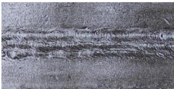
Рис. 1. Внешний вид стыкового соединения, выполненного электродом ЭПС-АН1
