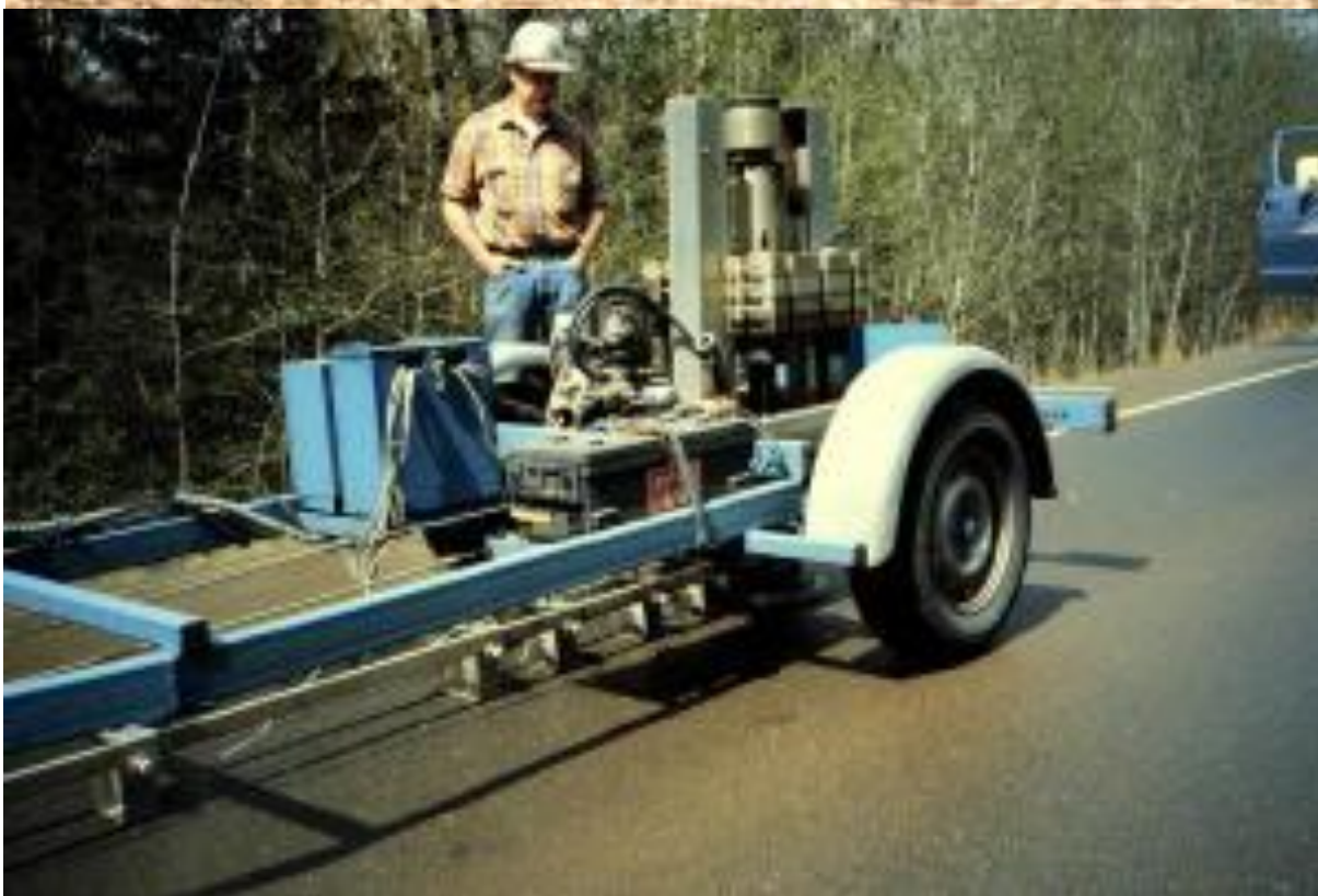
Рисунок 9.3 – Одна из модификаций дефлектометра FWD
