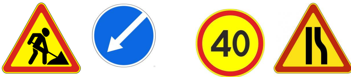
Рис. 4.5. Временные дорожные знаки, применяемые для навешивания на переносные опоры, треноги.
