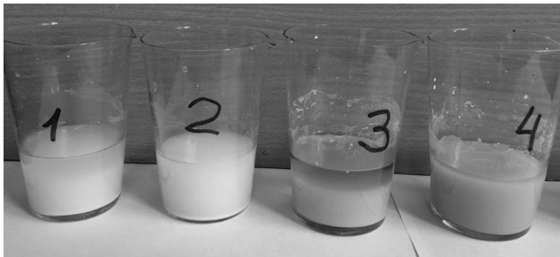
Рисунок 7. Эффективность обработки УДМК ультразвуком после 60 минут хранения в состоянии покоя, где 1 – 1 % УДМК, 2 – 1 % УДМК (обработка ультразвуком), 3 – 1 % УДМК + 0,5 %Ст, 4 – 1 % УДМК + 0,5 %Ст (обработка ультразвуком)
