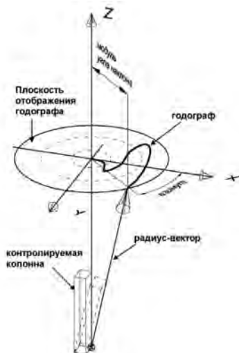
Рисунок 6. Схема отображения данных угловых отклонений колонн здания
