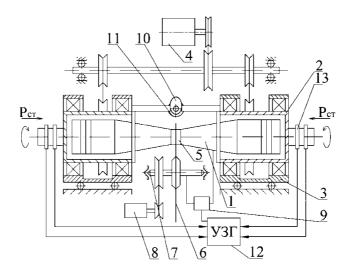
Изобретение относится к устройствам для поверхностной обработки материалов, в частности для шаржирования боковых поверхностей распиловочного диска алмазным порошком.
