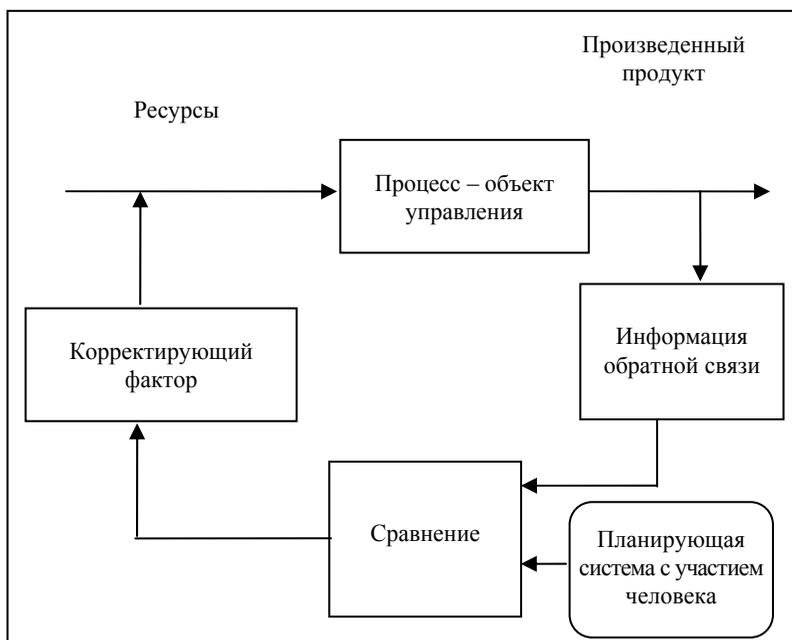
Рис 4.2. Общий процесс оперативного управления производством
