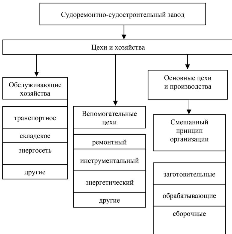
Рис. 1.9. Производственная структура ССРЗ
