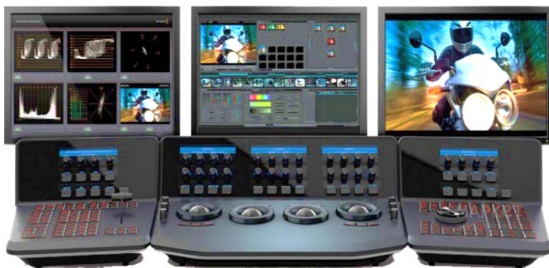
Рис. 4.11. Станция нелинейного монтажа
