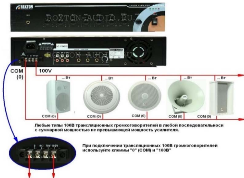
Рис. 8.12. Пример подключения трансляционного усилителя
