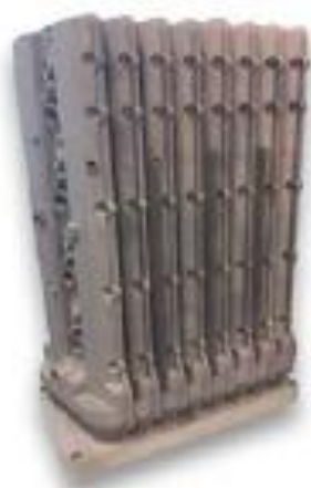
Рисунок 4 – 8 крышек блока цилиндров AlSiMg 265x735x65mm Бугатти (SLM 800)
