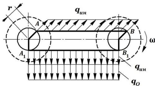
② Наиболее опасным для спарника является его *крайнее нижнее положение*  $A_1B_1$ , когда и его вес  $Q$ , и силы инерции  $F_{ин}$  направлены в одну сторону. В этом случае спарник работает на изгиб как шарнирно-опертая балка под действием равномерно распределенной нагрузки с интенсивностью, равной сумме интенсивностей инерционных сил  $q_{ин}$  и собственного веса  $q_Q$ :
