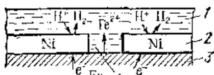
Рис. 13. Схема коррозии металла в кислом растворе при нарушении катодного покрытия: 1 — раствор; 2 — покрытие; 3 — основной материал; 4 — пора
