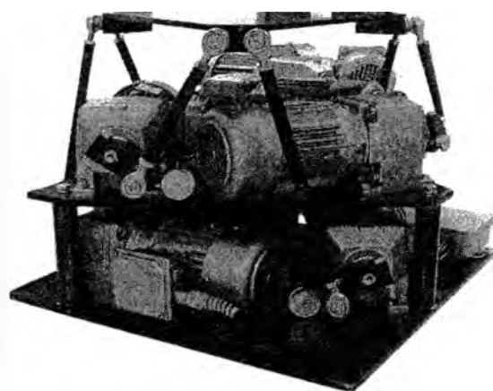
Рис. 1. Система перемещений с шестью степенями свободы
