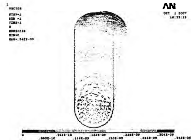
Рис. 4. Векторный график распределения перемещений узлов звена
