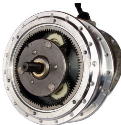
Рисунок 2. Мотор-колесо со встроенным редуктором планетарного типа
