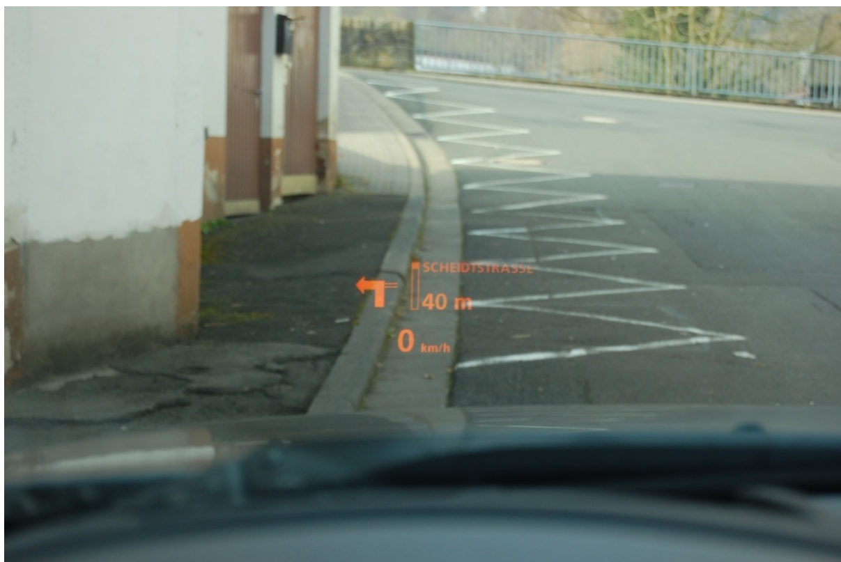
Рисунок 4. Первая продвинутая система проекции на лобовое стекло
