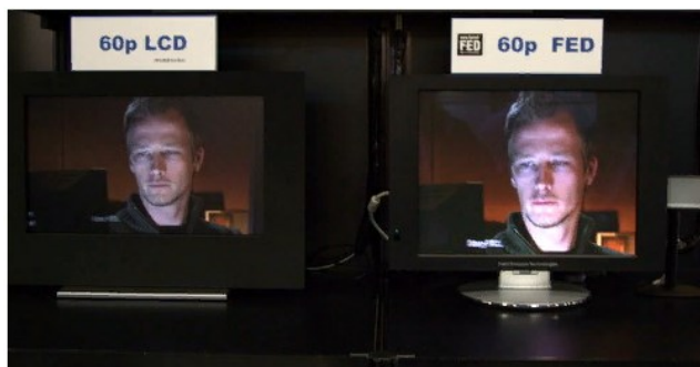
Рисунок 10. Изображение, показывающее преимущества качества изображения 60p LCD над FED 60p
