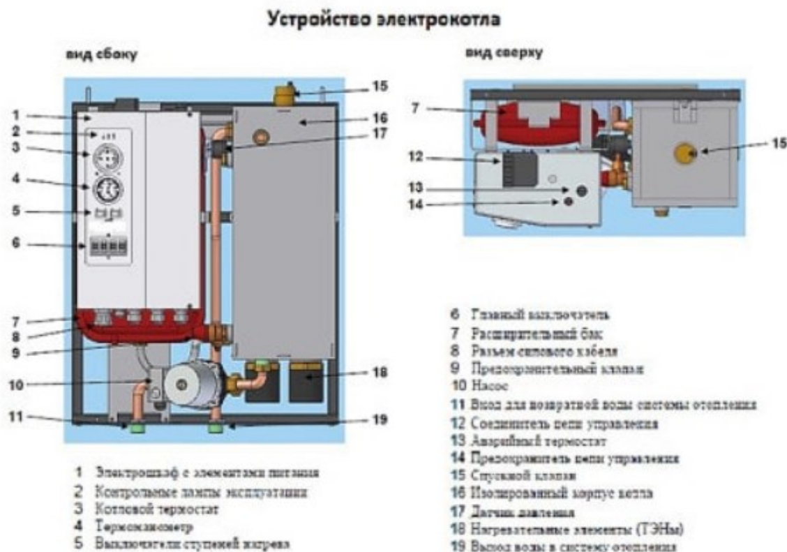
Рисунок 3 – Устройство стандартного электрического котла
