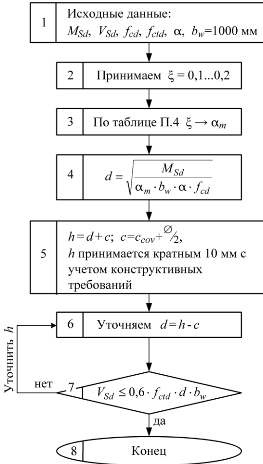
Рис. 2.5. Структура 1. Определение высоты сечения плиты
