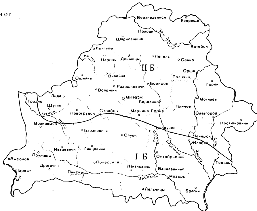
Рис. П.1. Районирование территории Республики Беларусь по весу снегового покрова
