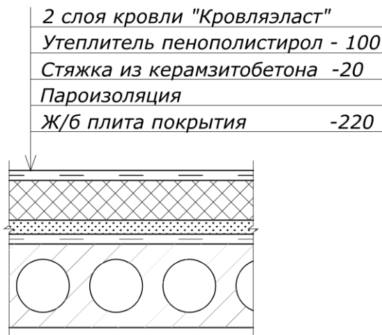
Рис. 4.1. Состав кровли
