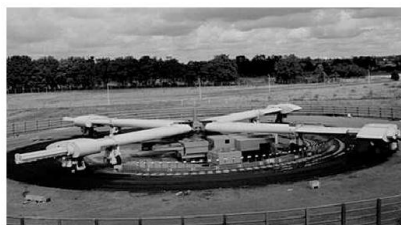
Рисунок 1.25 – Испытательный стенд и результаты испытаний на колееобразование
