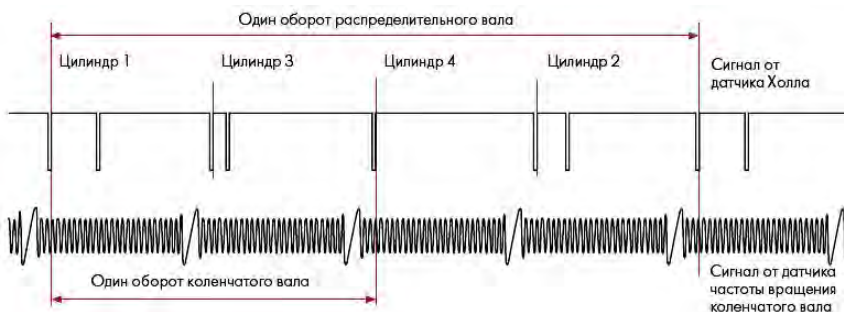
Рис. 5.21. Поступление сигналов от датчика Холла и от датчика частоты вращения двигателя
