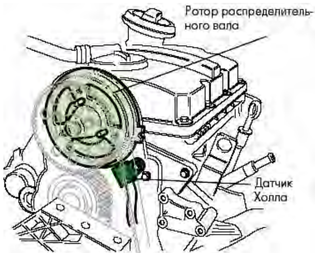
Рис. 5.16. Расположение ротора распределительного вала и датчика Холла
