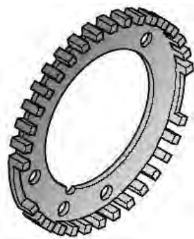
Рис. 5.20. Ротор датчика частоты вращения двигателя
