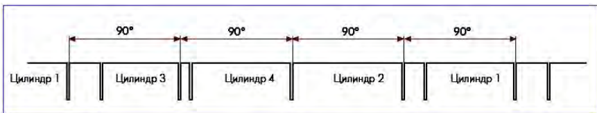
Рис. 5.18. Поступление сигналов от датчика Холла
