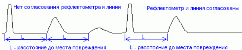
Рис. 8.3. Рефлектограммы кабельной линии без согласования и с согласованием выходного сопротивления
