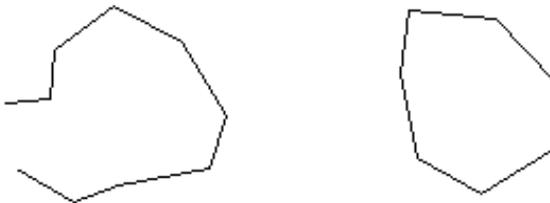
Рисунок 6.4 – Разомкнутая и замкнутая полилиния
