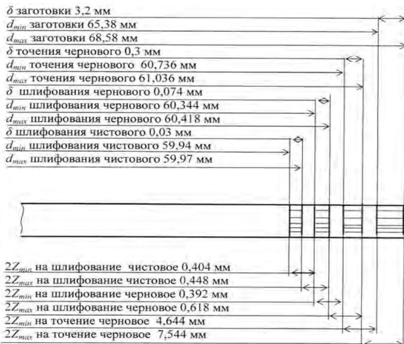
Рис. 5.3. Схема расположения припусков на обработку
