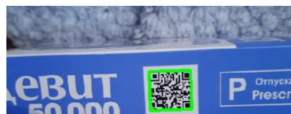
Рисунок 1- Результат сегментации штрихового кода на изображении
