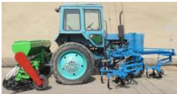
Рисунок 1 – Общий вид комбинированного агрегата для сева семян зерновых культур рядовым способом в междурядья хлопчатника
