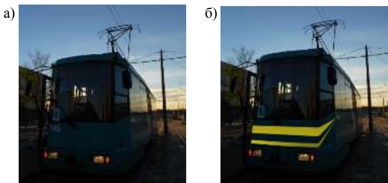
Рис. 1 – Условия различимости трамвайного вагона: а) с существующей окраской; б) с предлагаемыми дополнениями
