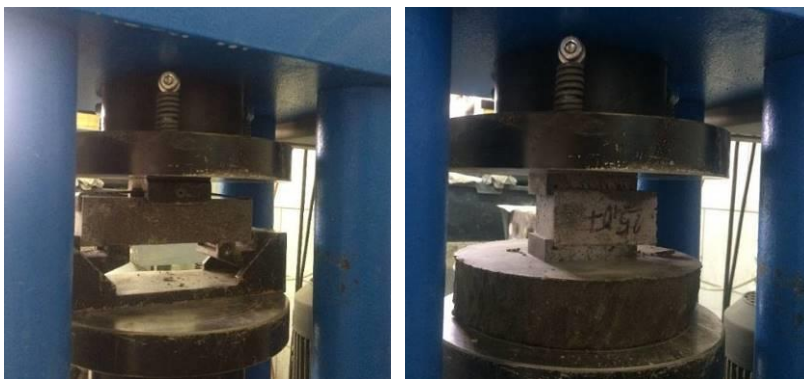
Рис. 4. Определение прочности а – при изгибе, б – при сжатии
