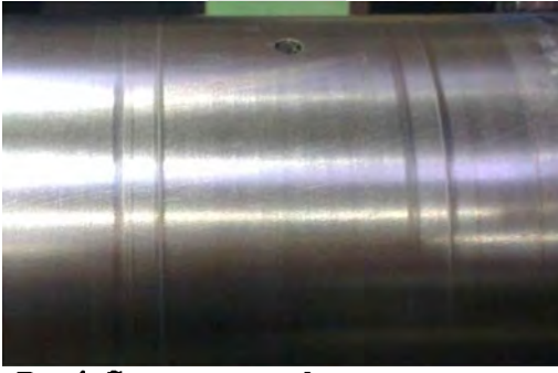
Рис.4. Состояние цапфы после эксплуатации
