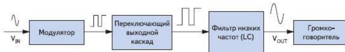
Рисунок 1 – Блок-схема усилителя класса D без обратной связи
