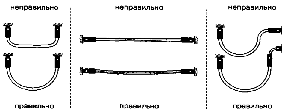
Рис. 17.3. Рекомендации по монтажу гибких трубопроводов
