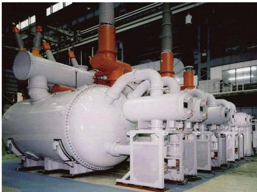
Рисунок 1. Силовой элегазовый трансформатор
