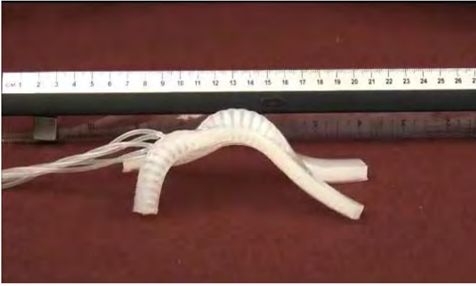
Рисунок 4 - «Soft Robot»-гофрированный мягкий робот
