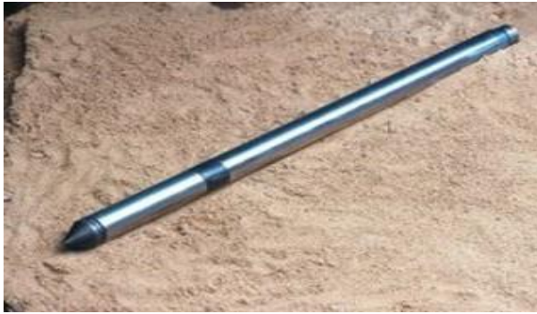
Рисунок 3. – Наконечник с электротензозмером
